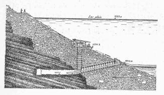
Fig. 46. — Puits G<sub>1</sub> et galerie inclinée g<sub>1</sub>. Echelle 1: 800.
