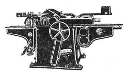
Machine à quatre faces pour roboter et moulurer Mod. DVS.
