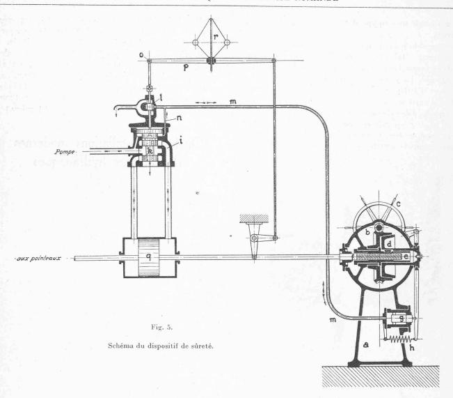
par un second mécanisme qui permet de faire dévier les deux jets en moins de 6 secondes. La déviation s'opère naturellement plus vite quand la charge n'est que partielle, les déflecteurs étant alors toujours sensiblement tangents aux jets.
