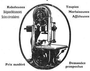
GRANDS STOCKS en SCIES A RUBAN diamètre des volants 700, 800, 900 mm. avec table inclinable. Toutes nos machines sont construites avec roulement à billes.
