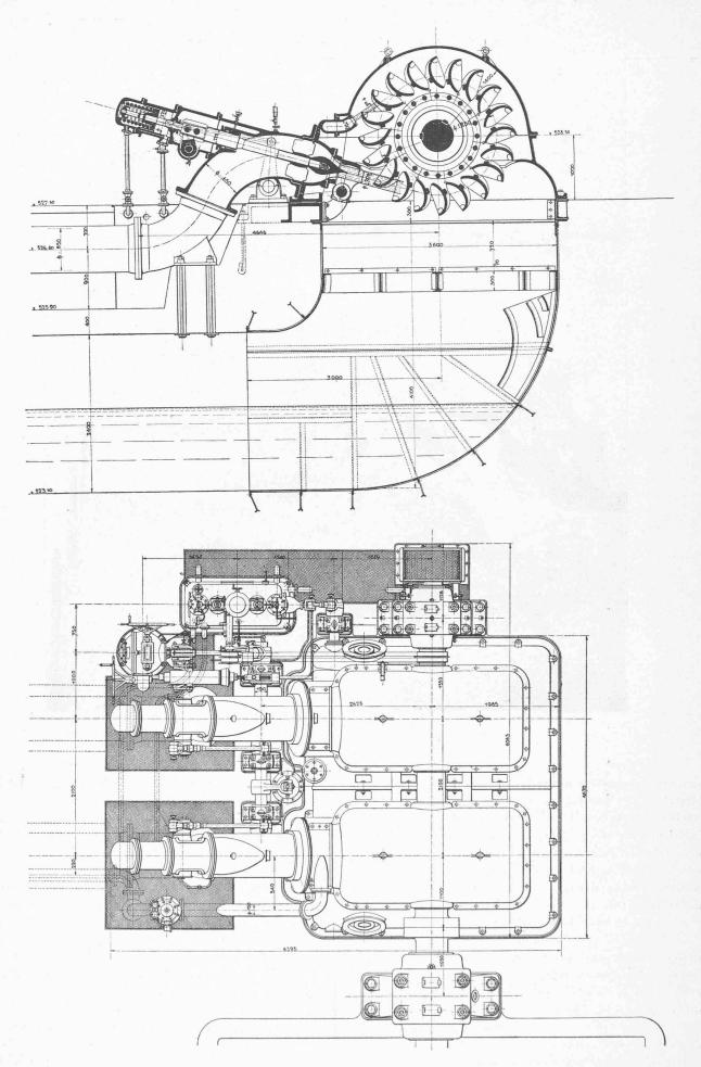
Fig. 3. — Turbine Pelton de 14 300 chevaux. — Echelle 1 : 60. Chute nette 275 m. — Débit 4730 lit./sec. — Vitesse 333 tours/min.
