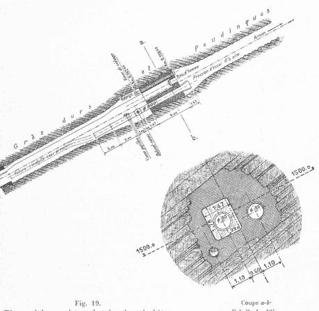
Tête aval du grand tunnel et bouchon de béton fermant le tunnel au km. 0 + 198. Echelle 1: 400.
