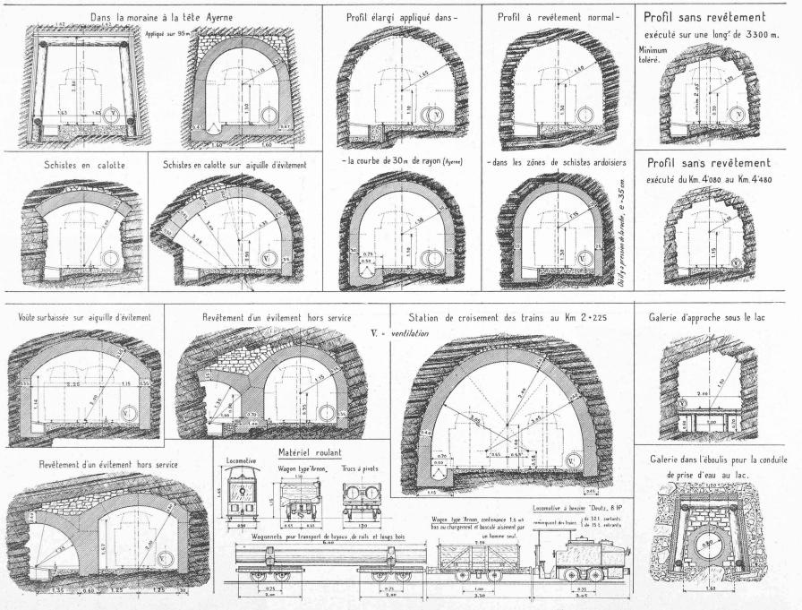
Fig. 18. — Les profils caractéristiques du tunnel Ayerne-Arnon. — Echelle 1: 100.
