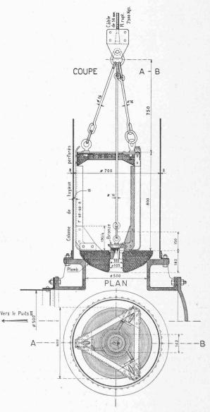
Fig. 14. Vanne nº 2 dans le Puits I. Echelle 1:20.
