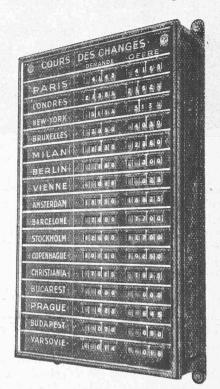
Fig. 2. — Tableau récepteur à 16 devises.
