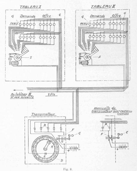
Schéma pour la commande à distance de tableaux indicateurs du cours des changes.
