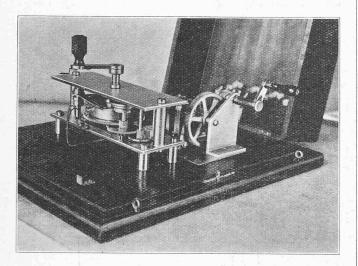
Fig. 9. — Appareil transmetteur ouvert.
