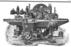
Machines à moulurer sur trois et quatre faces. - Raboteuses sur quatre faces spéciales pour la fabrication des parquets. Grandes raboteuses à trois et quatre faces pour menuiseries de bâtiment, scieries, etc. - Roulements à billes.
