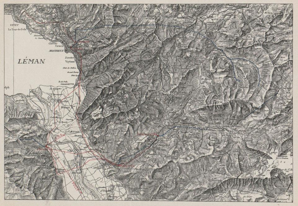
Fig. 1. — Carte des installations de la Société Romande d'Electricité. — Echelle 1: 125 000. En rouge: conduites électriques. — En bleu: canalisations hydrauliques.
