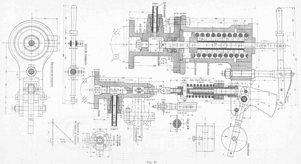
Vanne automatique de 500 mm. : appareil de commande à la main et automatique. Echelle 1 : 4.
