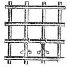
Utilisé comme attache pour fers à béton.
