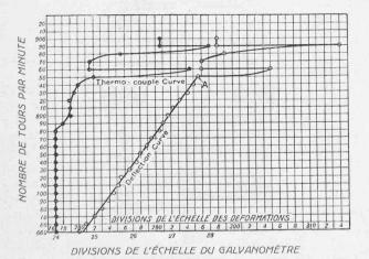
Fig. 2. - Nickel sollicité à la torsion alternative.
