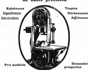
GRANDS STOCKS en SCIES A RUBAN diamètre des volants 700, 800, 900 mm. avec table inclinable.
