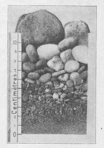
Fig. 41. — Alluvions prélevées dans l'eau de purge.
