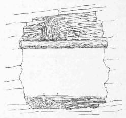
Fig. 13. — Ecrasement des couches schisteuses. Galerie II. Km. 6,710 à km. 6,860.
