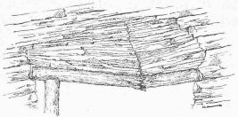
Fig. 9. — Ecrasement des couches schisteuses au faîte. Galerie I. Km. 6,810.
