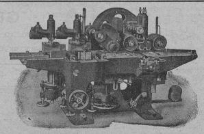
Machines à moulurer sur trois et quatre faces. sur quatre faces spéciales pour la fabrication des parquets. Grandes raboteuses à trois et quatre faces pour menuiseries de bâtiment, scieries, etc. - Roulements à billes.
