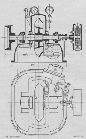
Fig. 3. - Coupe et plan d'une turbine «Turgo»
