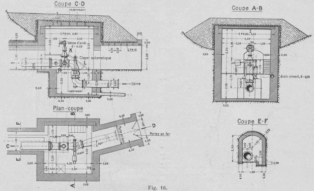
Chambre des vannes à la sortie du tunnel du lac. — Échelle 1:150.
