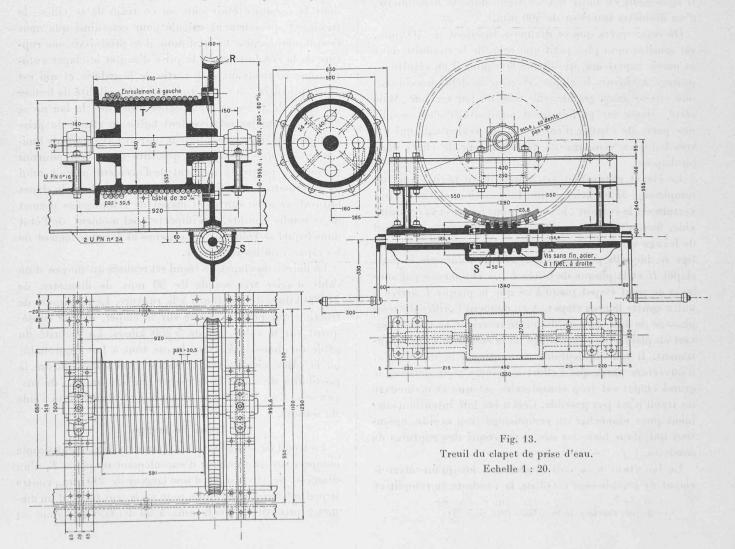
actionnée par une vis sans fin S et sur l'arbre de cette vis sans fin sont calées deux manivelles de commande, d'un rayon de 350 mm. (fig. 13).
