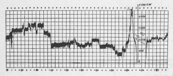
Extrait du diagramme du kw-mètre enregistreur de la station de réserve Diesel de Lugano.
