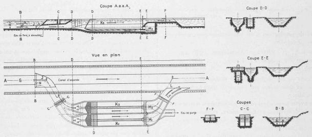
Fig. 38. — Dessableur automatique breveté, en dérivation sur un canal à grand débit. — Echelle 1: 800.
