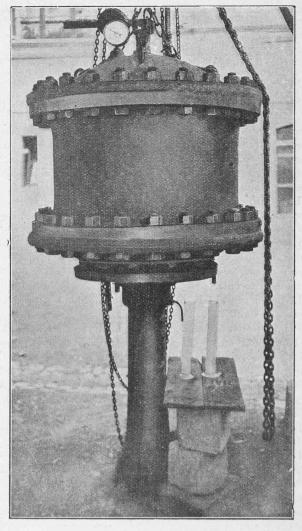
Fig. 4. — Appareil à haute pression pour l'étude de la perméabilité du béton, avec cylindre creux et bloc de béton placé à l'intérieur.
