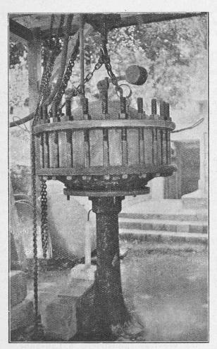
Fig. 3. — Appareil à haute pression pour l'étude de la perméabilité du béton sur bloc de béton serré.
