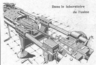
Essai de traction d'un câble métallique.
