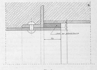
Fig. 2. Blindage de tunnels en charge, système Eydoux.
