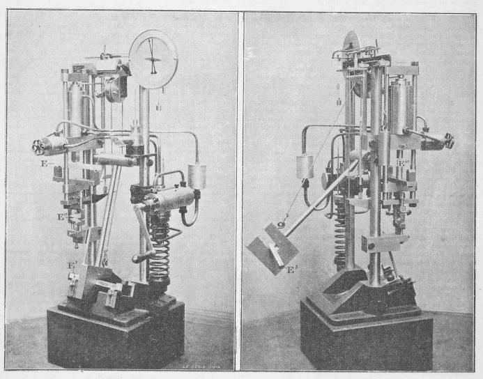
Fig. 8. Fig. Machine Amsler pour les essais statiques et dynamiques des bois.
