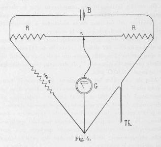
l'installation du tambour à moins d'une demi-division près nous pouvons déterminer les résistances à  $0,016\,\Omega$  près, ce qui correspond à  $0^{\circ}04$ . Nous nous sommes d'ailleurs contenté de mesurer le  $^{1}/_{10}$  de degré. Le pont a été étalonné sur une résistance normale et une table de calibration a été dressée.
