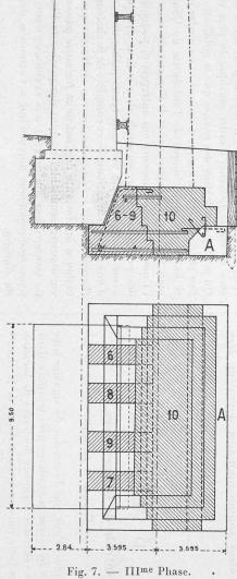
Bétonnage des tranches 6 à 9, enlèvement successif des contre-fiches. bétonnage du bloc 10.
