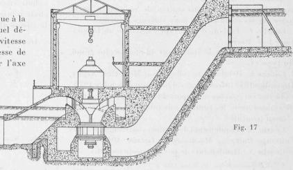
métrique de 10 m. 33. Dans les exemples qui suivent, cette limite srea fixée à 8 m. 15. Avec cette condition, si une roue est située à 5 m. 15, au-dessus du niveau aval il ne reste que 3 m. comme limite de la chute-vitesse utilisable, en tenant compte cependant, des pertes dans le tuyau d'aspiration, de la répartition inégale des vitesses, et de l'augmentation de vitesse lorsque la turbine travaille à pleine ouverture.
