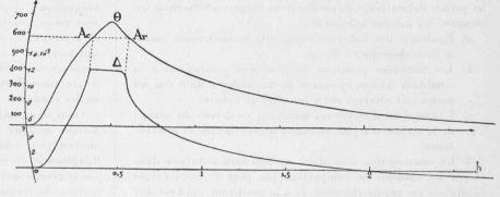
Fig. 3. — Anomalie de la dilatation du quartz.
