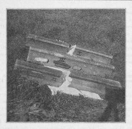
Fig. 9. — Destruction de coupons de rail.
