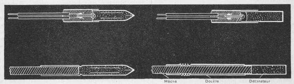
Fig. 5. — Capsule détonante à allumage par mèche.
