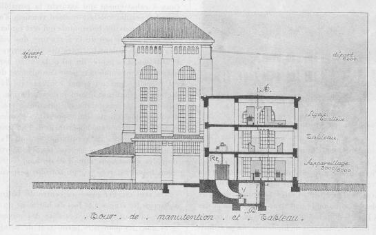
Fig. 45 — Coupe de l'usine de Pierre-de-Plan.
