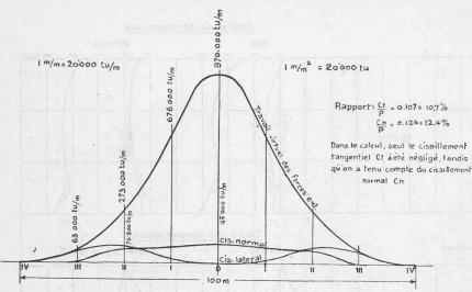
Fig. 24. — Diagramme du travail virtuel de déformation.
