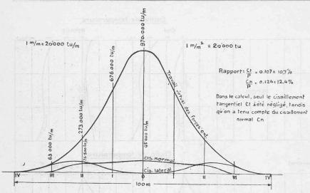
Fig. 24. — Diagramme du travail virtuel de déformation.
