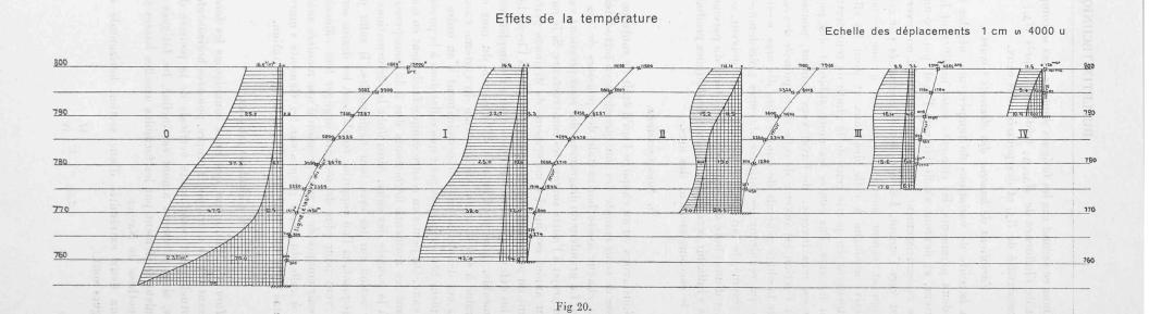
Dans ce second cas les fatigues dans les arcs se composent de l'influence de  $R_{\Delta t + \Delta \tau}$  (réduites d'après  $R_{\Delta t}$ ) de l'excentricité de  $R_{\Delta t}$  et des poussées des eaux.
