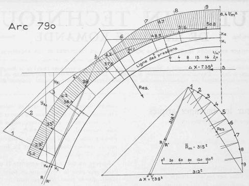
Fig. 19. — Poussées sur l'arc et ligne des pressions.
