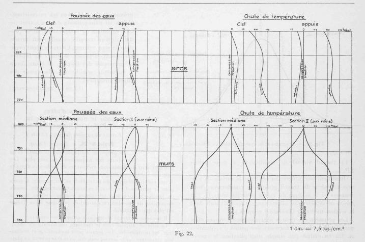
du calcul des fatigues qui ne présente pas de difficultés. Le diagramme fig. 22 donne les fatigues pour la poussée des eaux et la chute de température. Dans le cas de l'arc il se trouvera des sections qui sont soumises à un effort de traction oblique, c'est-à-dire une composante normale de traction et une composante tangentielle de cisaille-
