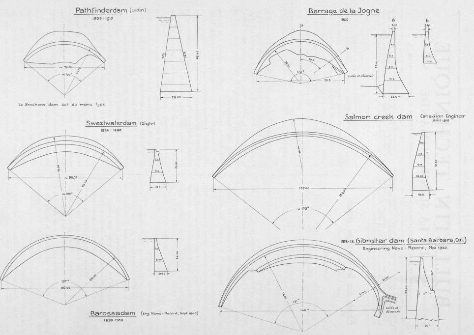
Fig. 1. — Quelques exemples de barrages arqués de grandes dimensions. — Echelle 1 : 1500.
