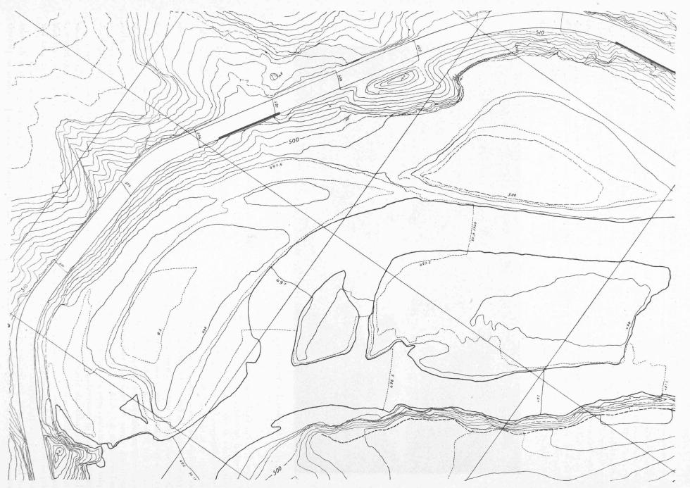
Fig. 11. — Levé stéréoautographique des rives et du régime d'un torrent, à la date du 30 novembre 1920, d'après la photographie fig. 10. — Echelle 1: 1000.
