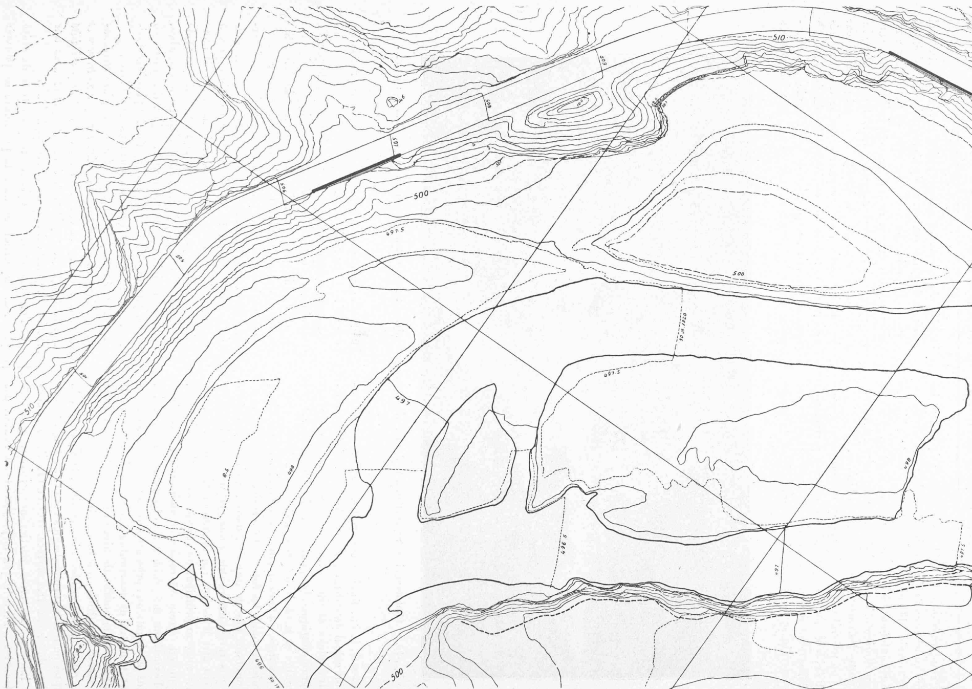
Fig. 11. — Levé stéréoautographique des rives et du régime d'un torrent, à la date du 30 novembre 1920, d'après la photographie fig. 10. — Echelle 1 : 1000. Equidistance des courbes 0,5, 1,0 et 2 m. (Bureau de stéréotopographie du Dr Helbling, à Flums.)
