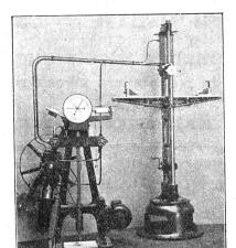
Machine de traction de 10 tonnes avec dispositifs de compression, de flexion et de pliage.
