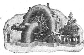
Turbine spirale avec régulateur à pression d'huile, 5600 HP sous 160 m. de chute.
