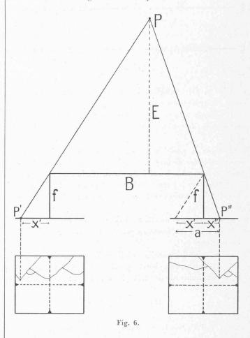
niers soient les mêmes qu'aux verniers correspondants du comparateur, il est facile de se rendre compte que le levier des directions donne la projection horizontale de la visée allant de la position de gauche au point, que le long bras du levier des hauteurs donne la projection verticale de la même visée rabattue sur un plan horizontal et que le levier des parallaxes correspond à la projection horizontale de la visée allant de la position de droite au point cherché (fig. 7).
