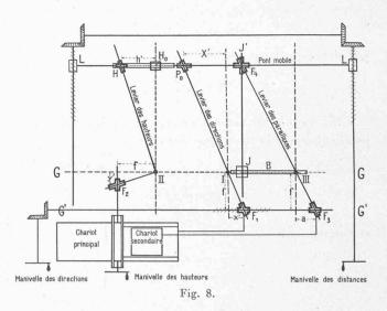
levier des parallaxes au chariot secondaire, portant le cliché de droite, par le guidage  $F_3$ , tandis que le pont mobile est relié au levier des parallaxes par le guidage  $F_4$  qui coulisse le long de l'axe J-J'. Les trois leviers sont mus par des manivelles dites des directions, des hauteurs et des distances.
