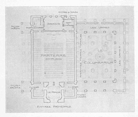
Fig. 3. — Plan du rez-de-chaussée. — 1:400.
