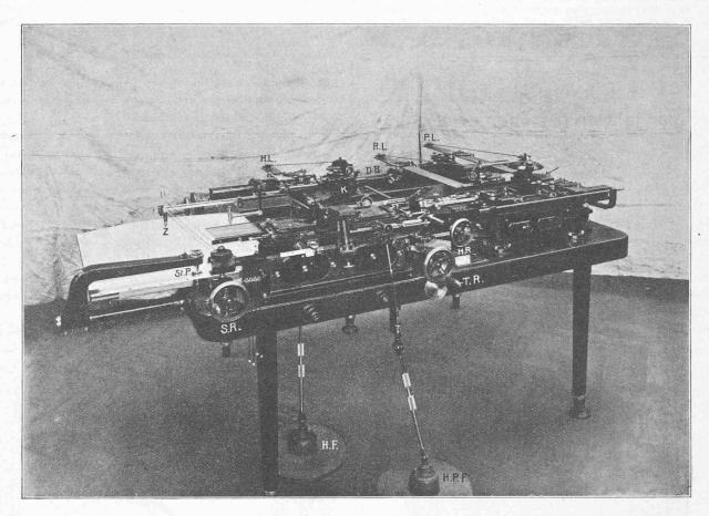
Fig. 5. — Stéréoautographe, modèle 1914.
