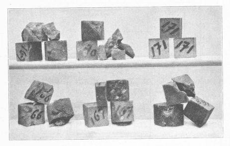
Fig. 1. — Eprouvettes de béton de scories.
