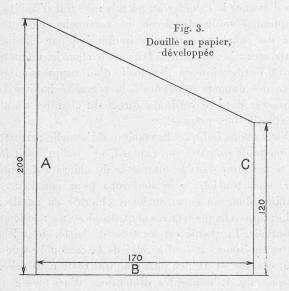
en laissant dépasser le côté A de 1,5 cm. Rouler ensuite le papier autour du bois, fermer le côté A et coller la partie fermée avec de la parassine fondue (fig. 3 et 4).
