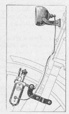
Fig. 1. — Magnéto d'éclairage électrique pour bicyclette. Modèle « Lucifer ».
