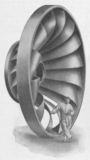
Fig. 4. — Roue motrice à grande vitesse des turbines de l'usine de Mauzac sur la Dordogne. Diamètre 5060 mm. — Poids 31 tonnes. — Puissance 2700 HP. Chute 4,3 m. — Vitesse 55 t/min.
