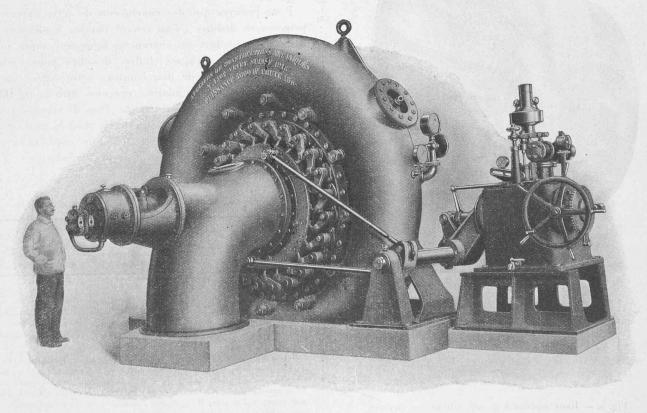
Fig. 3. — Turbine Francis, à bâche spirale, avec régulateur à pression d'huile. Chute 160 m. — Puissance 5600 HP. — Vitesse 500 t/min.
