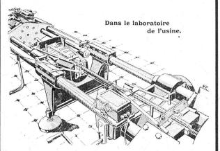
Essai de traction d'un câble métallique.
