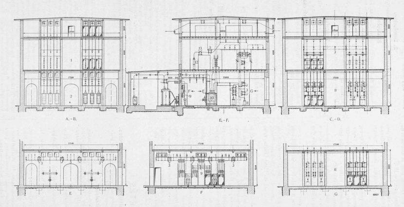
Fig. 27. — Transformateurs et tableau côté 50,000 volts. — Elévation.
