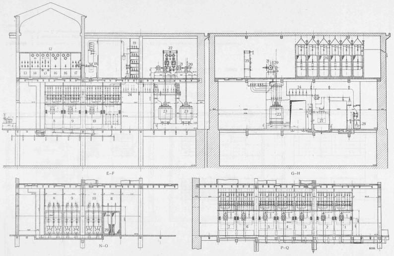
Fig. 25. — Tableau 6500 volts. Elévation II.
