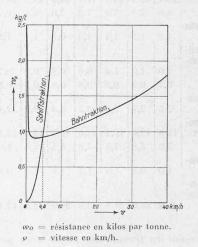
Fig. 2. — Résistances à la traction sur rail (Bahntraktion) et sur l'eau (Schiffstraktion) en palier et en alignement droit.
