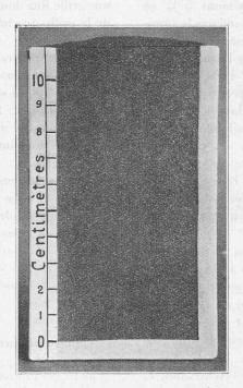
Fig. 33. — Alluvions prélevées aux points morts du château d'eau, après la construction du dessableur.
