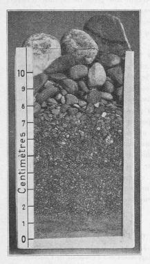
Fig. 32. — Alluvions prélevées dans le château d'eau de l'usine de Monthey, avant la construction du dessableur.
