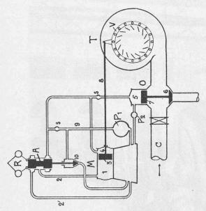
Fig. 11. - Schéma du réglage de la turbine.
